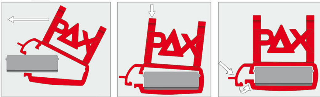
Fest verriegelter PAX-Ampullenclip Locked PAX-ampoule-clip
